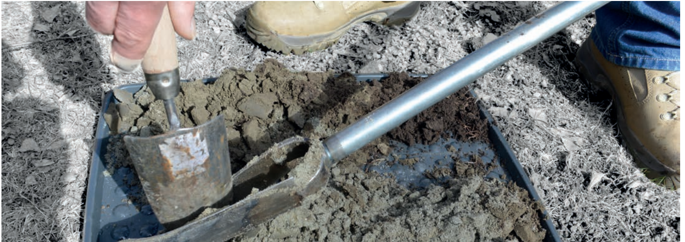
Die AefU gaben eigene Quecksilberanalysen von Gartenerde in Auftrag. Hier wird die Bodenprobe (Bohrkern) aus dem Bohrer gelöst.
