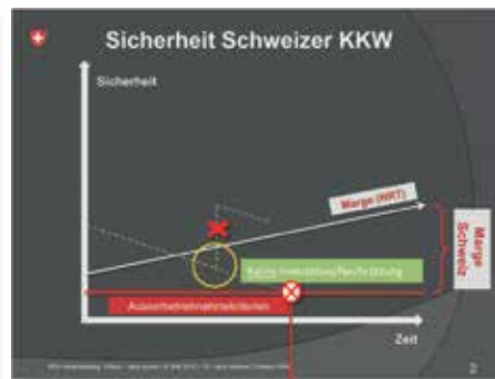
Abb. 1+2: Die Sicherheit eines AKW gemäss ENSI. 6 Graue Linie: Stand der Nachrüstungstechnik, bei Unterschreitung müssen die AKW-Betreiber Nachrüstungen, die als angemessen gelten, vornehmen. Rote Linie: absolutes Sicherheitsminimum, bei Unterschreitung müssen die Betreiber das AKW unverzüglich vorübergehend abschalten. NRT = Nachrüstungstechnik.
