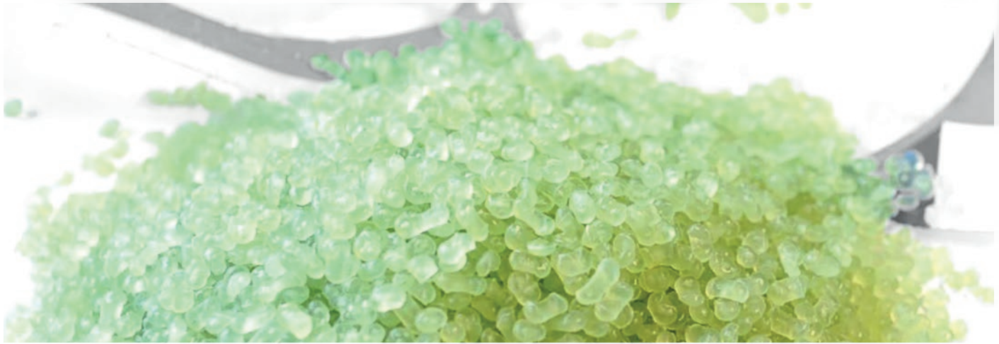
Aus Produktionsstanzabfällen hergestelltes PLA 3 -Regranulat.
