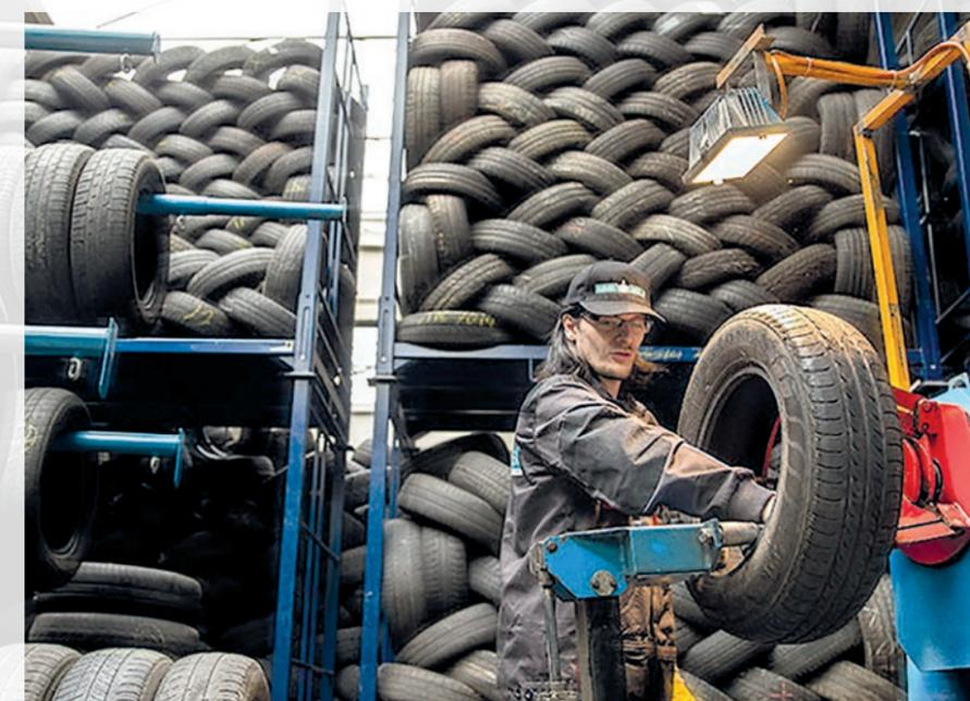
Der abgeahrener Reifen bildet die Basis für die «Runderneuert» und muss nach strengen Kriterien ausgesucht werden.
